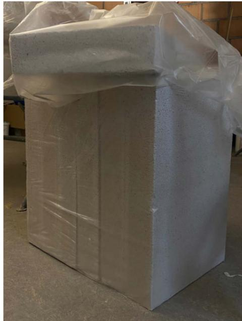
Ytong besteht aus Kalk, Zement, Sand und Luft. Bei der Produktion entstehen winzige luftgefüllte Poren, welche mehr als die Hälfte des Baustoffs ausmachen. Dies ist auch der Grund für das tiefe Gewicht und dass das Material einfach zu bearbeiten ist.
