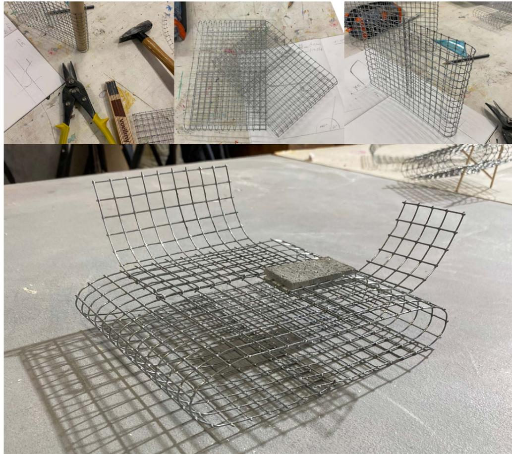
Modelle für mehr räumliches Verständnis und ein genaueres Vorstellungsvermögen für die Grösse des Objekts. Anschliessend verschiedene Tests, um ein Betonelement für eine Abstellfläche nachzubilden. Zuerst aus Styropor und dann aus Karton. Ich entschied mich dann, die „Ablagefläche“ mit Betonspachtel zu giessen.
