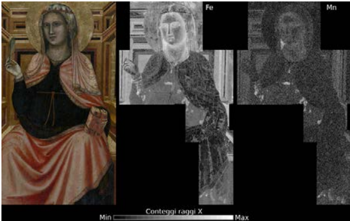
Fig. IV: Santa Cecilia in trono - Visibile e mappe di distribuzione dei raggi X del ferro (Fe-serie K) e del manganese (Mn-serie K) ottenute con XRF a scansione della rete INFN-CHNet. Le mappe di distribuzione riportate sono ottenute dall'unione e-rielaborazione di 7 aree differenti. La mappa di distribuzione del ferro suggerisce nelle ombreggiature e nella struttura del trono l'uso di ocre e terre. In questo caso, la compresenza di ferro e manganese, ben visibile nella struttura del trono e in misura minore nei dettagli del volto, può suggerire l'uso di una terra bruna, quale la terra d'ombra (ossido idrato di ferro e manganese).
