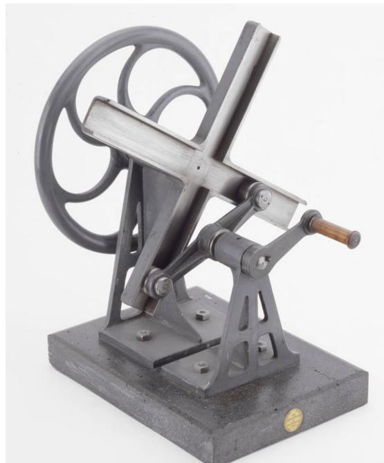
Fig. 6. Manovellismo con guide per trasmettere il movimento fra assi paralleli ma non allineati, 1860 circa, J. Schroeder a Darmstadt, Firenze, Museo della Fondazione Scienza e Tecnica.
