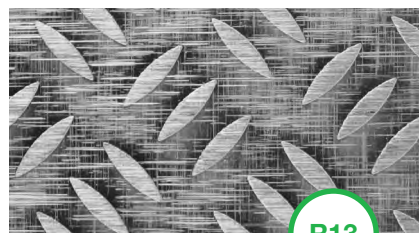
3 SE-TB1 (636) längs und quer überschleifen léger meulage longitudinal et perpendiculaire additionnel
