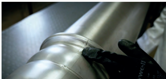
Bild 30 – Sichtkontrolle beim Verpressen von Übergrößen
