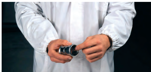
Image 24 – Vérification du joint d'étanchéité
