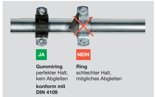
Bild 43 – Gummiring PRATIKO in Konformität mit DIN 4109
