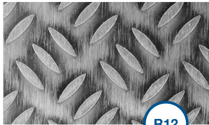
2 SE-TB1 (604) längs überschleiffen léger meulage longitudinal additionnel
