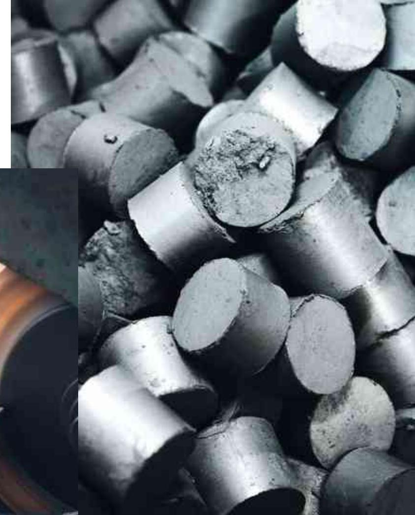
Oben rechts: Der Schleifschlamm wird getrocknet, zu Briketts gepresst und als Rohstoff wiederverwertet.
