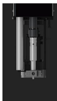
3 真空打开,吸嘴吸附螺钉,夹爪打开并旋转回存钉位
