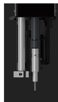
4 工具下行,开始拧紧工作,下一个螺钉吹送至存钉位
