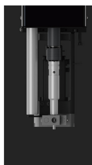
3 真空打开,吸嘴吸附螺钉,夹爪打开并旋转回存钉位
