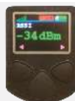
Verificación en tiempo real de potencia Wi-Fi
