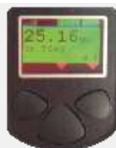
Resultado del atornillado en la pantalla OLED
