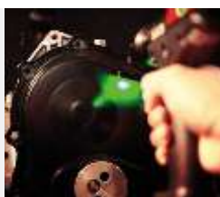
Indicador luminoso OK/NOK proyectado directamente sobre la zona de uso
