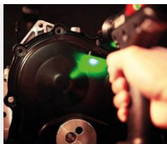
Lumière du voyant OK/NOK directement projetée sur la zone d'utilisation
