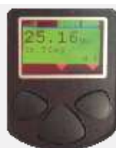
Resultado do aparafusamento no ecrã OLED
