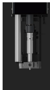
3. Le tube descend pour saisir la vis par aspiration, la pince s'ouvre, puis il revient en position d'alimentation
