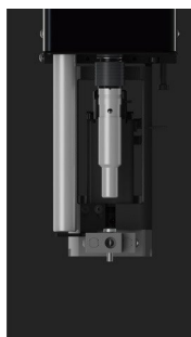
2. La pince se déplace du point d'alimentation au point de prélèvement
