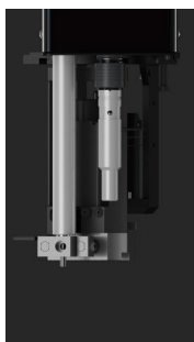
1. Démarrage : une vis est acheminée par le distributeur de vis
