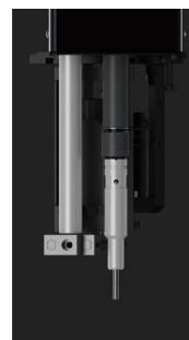
4. A chave de fendas desce para apertar e, em seguida, sobe. Um novo parafuso é introduzido durante a descida para reduzir o tempo de ciclo
