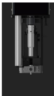
2. A pinça desloca-se do ponto de alimentação para o ponto de recolha
