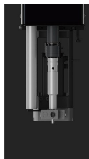
3. O tubo desce para recolher o parafuso por sucção, a pinça abre-se e regressa à posição de alimentação
