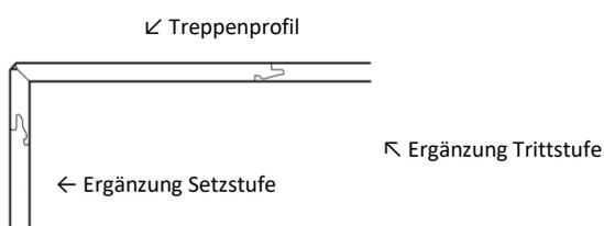
(Beispiel einer Treppenstufe für eine gerade Treppe. Das Treppenprofil und die zusätzlichen Planken für Setz- und Tritstufe.)
