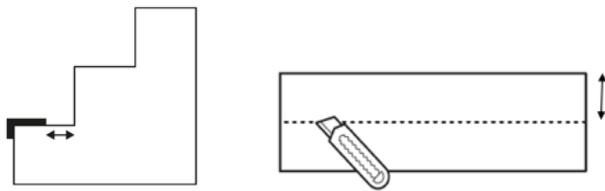
*Tipp:* Bei Treppen, die nicht gerade sind oder eine (halb-)runde Form haben, können Sie die Trittstufe vor dem Zuschneiden zuerst in das zugeschnittene Treppenprofil einklicken.
