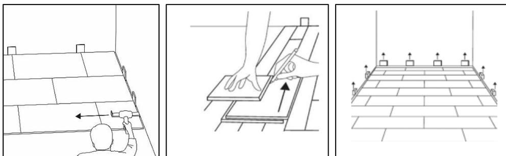
1. Para la colocación de la última fila, tendrás que cortar las baldosas a lo largo. Para colocar las fichas en el sistema de clic de la fila anterior, puede utilizar una plancha metálica. Tenga cuidado: golpear de manera desigual o golpear demasiado fuerte puede dañar la baldosa y sus juntas de clic.
