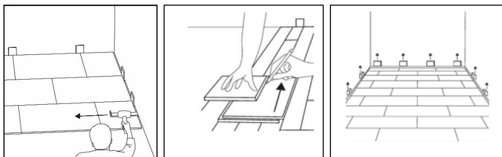
1. Für die Verlegung der letzten Reihe müssen Sie die Fliesen in Längsrichtung sägen. Sie können die Fliesen mit einem Zugeisen in das Klicksystem der vorherigen Reihe einfügen. Bitte beachten Sie: ein zu hartes oder zu ungleichmäßiges Anschlagen der Bretter kann die Bretter und ihre Klickverbindungen beschädigen.
