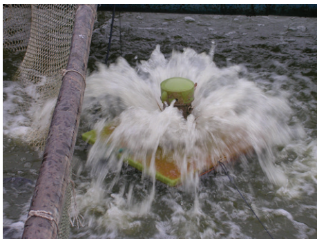
Po lewej: system RAS zanurzony w stawie - jednostka intensywnego chowu i hodowli napowietrzana za pomocą podnośnika powietrznego. Środek: Napowietrzacz ustawiony z boku sadzu. Po prawej: Schemat działania napowietrzacza (1. Dmuchawa. 2. Ciągłe zasysanie wody i 3. Ciągły przepływ wody.)
