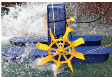
Powierzchniowy napowietrzacz łopatkowy o wydajności: SAE: 1,2-2,9 kg O 2 /kWh
