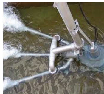
Napowietrzacz strumieniowy w wodzie o wydajności: SAE: 2,4 kg O 2 /kWh
