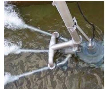
Струйный аэратор с эффективностью SAE: 2,4 кг O<sub>2</sub>/кВт-ч
