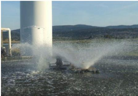
Распылительный аэратор с эффективностью SAE: 0,06-0,17 кг O<sub>2</sub>/кВт-ч
