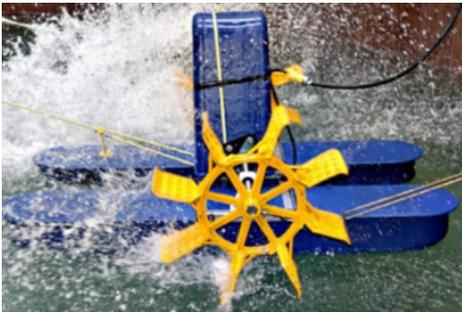
Поверхностный, лопастной аэратор с эффективностью SAE: 1,2-2,9 кг O<sub>2</sub>/кВт-ч
