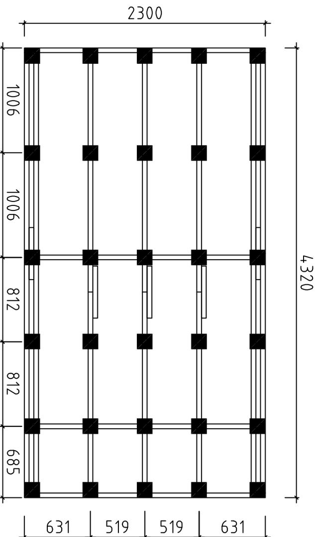
Detta är ett förslag för hur man kan placera plintarna (100-200 mm i diameter) för golvbjälkaget. Golvbjälkarna är med i byggsatsen, men inte plintarna. Använder man exempelvis 500-600mm långa murblock så kan man halvera antalet punkter. Lägg fuktskyddande papp mellan betong och trä
