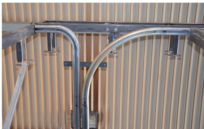
Provisorische Montage im Werk: Gut zu sehen ist der Verlauf der Trag- und Führungsschienen.
