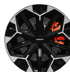
20"GT alufæge, bremseskiver & faste 4-stemplede bremsekalibre (for), orange lakerede kalibre
