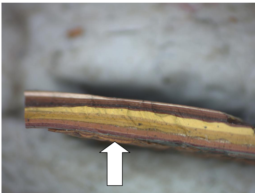
Fot.10. Powiększenie pod mikroskopem przez przekrój poprzeczny warstw próbki farb z nadświetla bramy kamienicy przy ul. Limanowskiego 24 w Stargardzie. Widoczna bardzo duża ilość przemalowań w różnych odcieniach brązów od bardzo jasnych do bardzo ciemnych. Ostatecznie naliczono 21 warstw. Strzałką zaznaczono najstarszy, oryginalny kolor stolarki występujący jako pierwszy na powierzchni drewna nadświetla. Jest to jasny, ciepły ugrowy brąz. (fot. L. Piotrowska- Cześnik).
