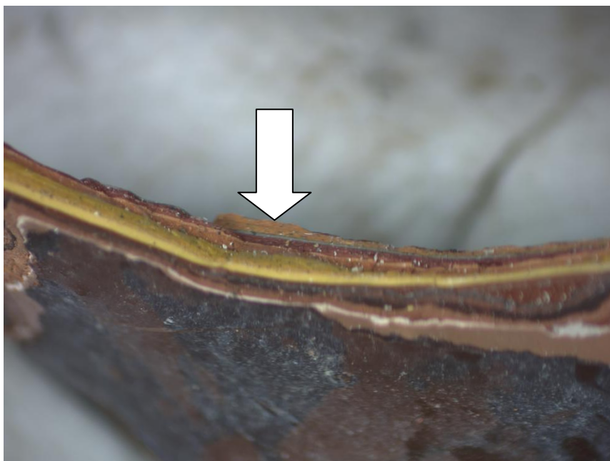
Fot.9. Powiększenie pod mikroskopem przez przekrój poprzeczny próbki z warstwami farb z nadświetla bramy kamienicy przy ul. Limanowskiego 24 w Stargardzie. Strzałką zaznaczono pierwszy, najstarszy kolor występujący na drewnie. Jest to jasny, ciepły ugrowy brąz. (fot. L. Piotrowska-Cześnik)
