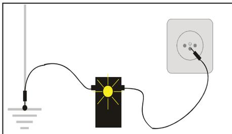
NIN 6.1.3.2 B+E Prüfung der Leitfähigkeit des Schutzleiters sowie der Wirksamkeit des Schutzpotenzialausgleich und des zusätzlichen Schutzpotenzialausgleichs ( max. 1 Ω )
