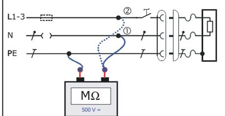
Isolationsmessung bei elektronischen Geräten?
