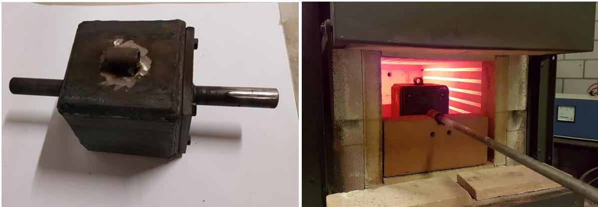
Abb. 5.1: "Drehrohrföfen" des UMTEC. Der ca. 2 L Volumen fassende Stahlbehälter kann im Muffelofen des UMTEC erhitzt und rotiert werden. Hierdurch kann das Schürverhalten in der KVA simuliert werden. Durch die hohle Rotationsachse kann Spülgas in den Behälter eingeführt werden, z. B. Stickstoff, Luft, oder Sauerstoff.
