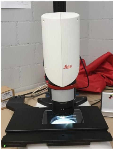
Abb. 3.2: *Digitales Lichtmikroskop Leica DVM 6M am UMTEC*
