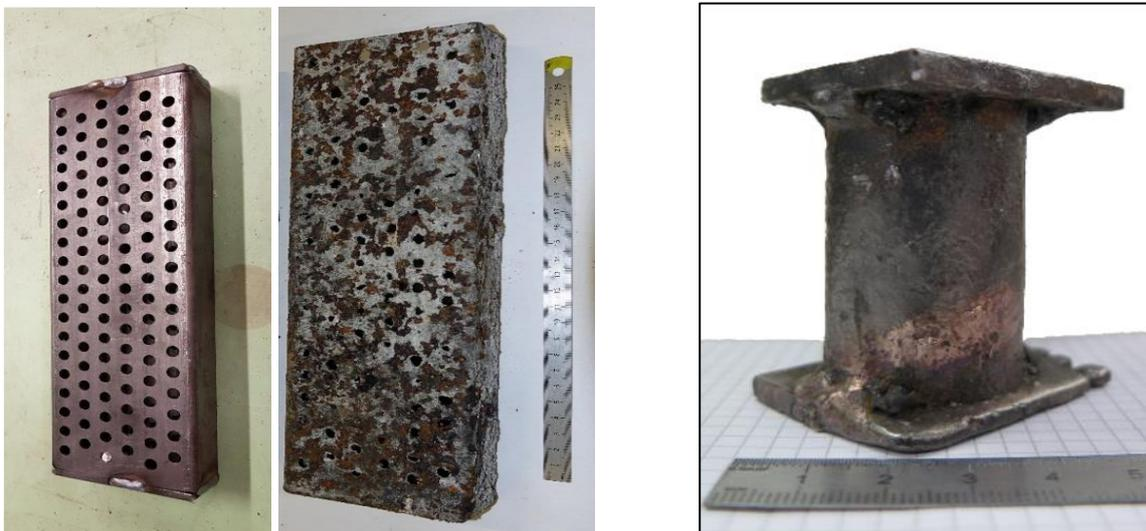
Abb. 5.2: links: "offener Stahlkäfig" vor dem Einwurf in die KVA und nach Herauslesen aus der (nass ausgetragenen) Schlacke.
