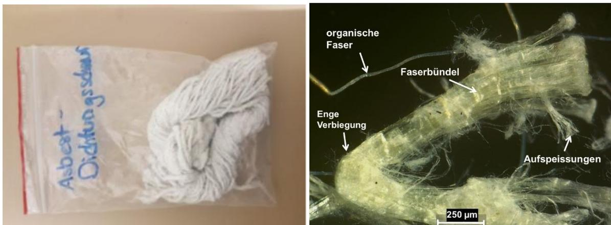
Abb. 3.1: Dichtschnur links ohne Vergrösserung und rechts unter dem Mikroskop.
