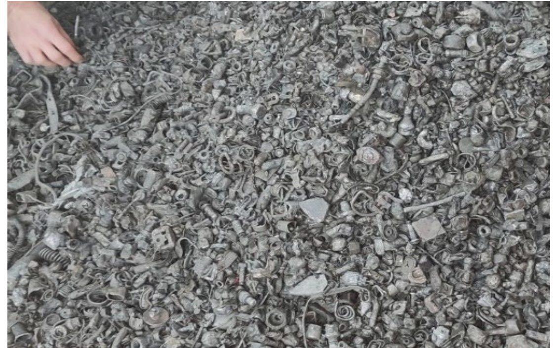
Feineisenschrott nach dem Shreddern: sehr sauber!
