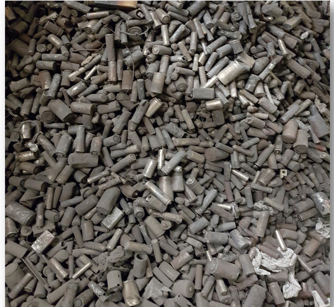
Batterien aus Feineisenschrott Trockenaustrag
