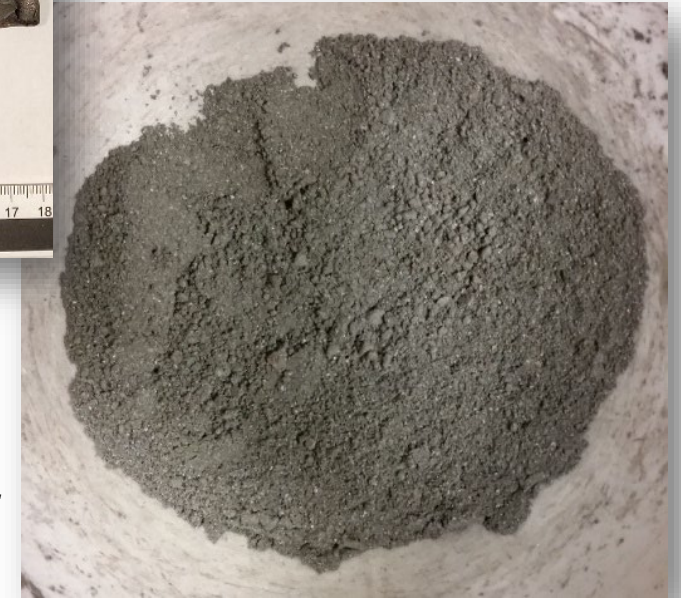
Inhalt der Batterien: «sandiges» Material <4mm.
