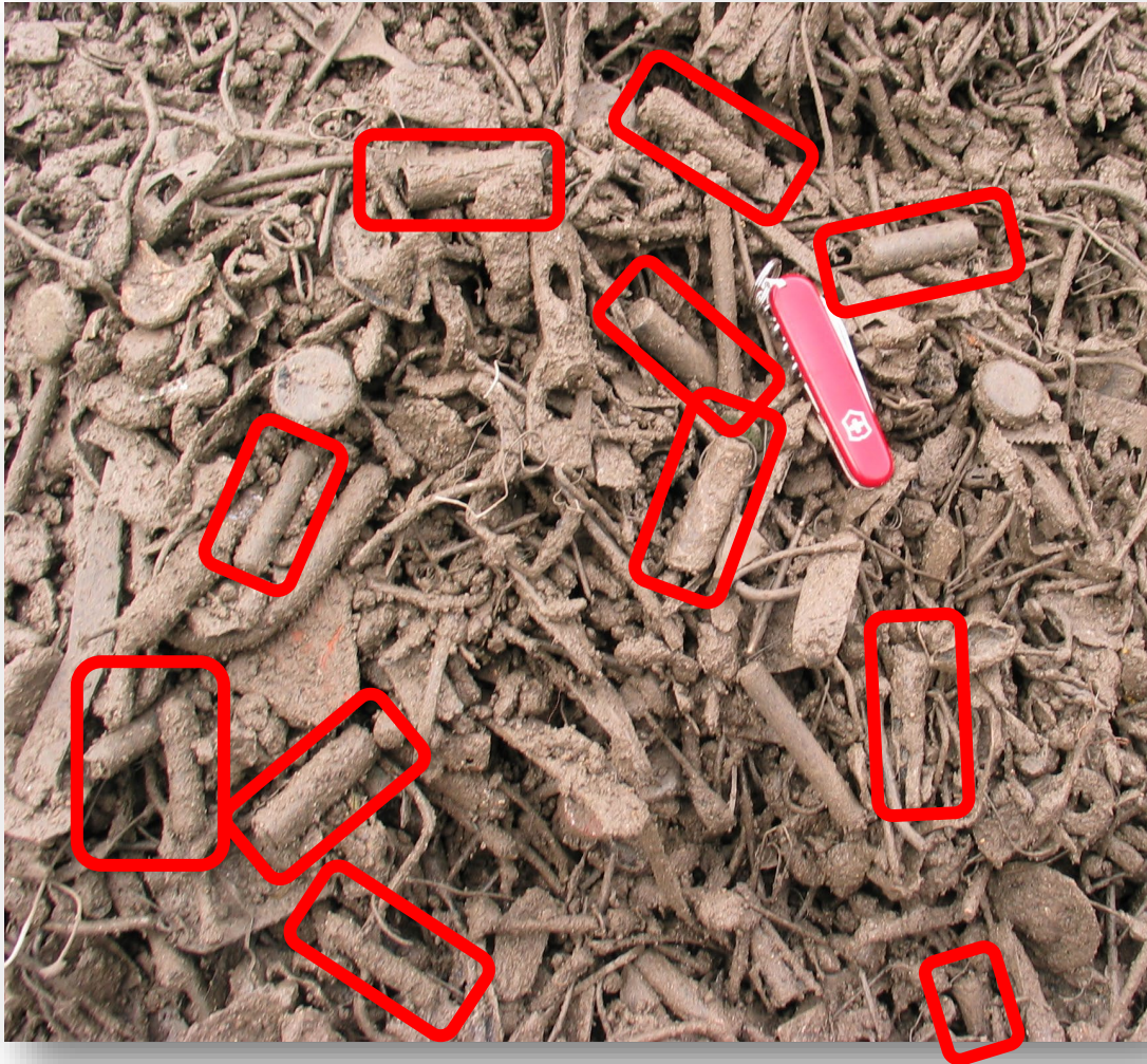
Feineisenschrott Nassaustrag: ca. 1-2% Batterien
