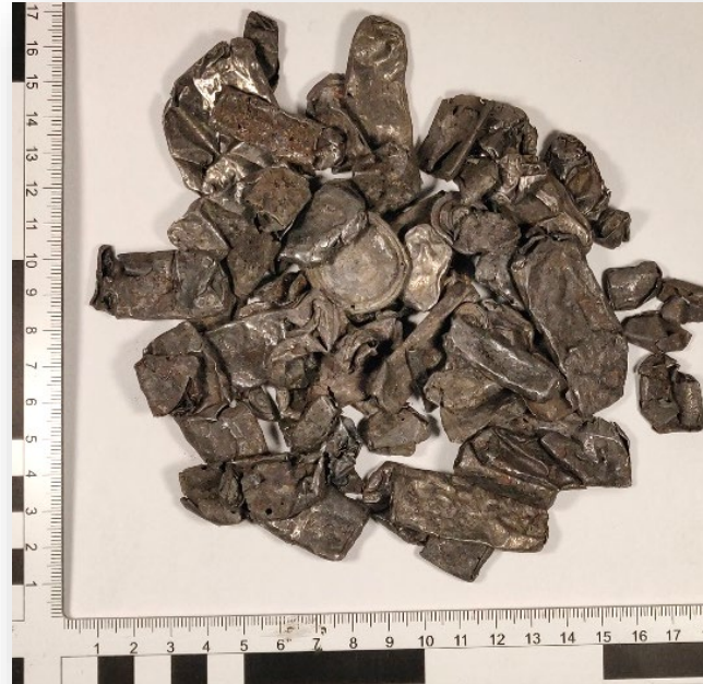
Versuch im Labor: Stahlmäntel der geschredderten Batterien
