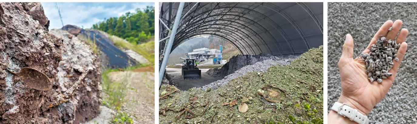
In Verbrennungsrückständen wie Schlacke von KVA sind wertvolle Metalle enthalten. Diese werden oft in Aufbereitungsanlagen zurückgewonnen, bevor die entfrachtete Schlacke abgelagert wird. Das linke Bild zeigt die KVA-Schlacke vor der Aufbereitung, das mittlere im Hintergrund eine Aufbereitungsanlage und das rechte die rückgewonnene Nicht-Eisen-Fraktion.
