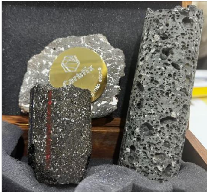
Abbildung 5: Bohrkern aus dem CarbFix Reservoir, welche die poröse basaltische Reservoirmatrix (grau) zeigen und die neu gebildeten Karbonatminerale (= das gespeicherte CO 2 ) in Weiss ( www.carbfix.com ).
