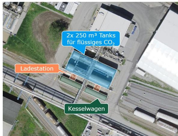
Abbildung 5-7 Beispiel CO<sub>2</sub> Verladung Kesselwagen.
