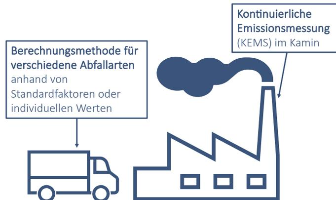
*Die fossilen Emissionen bei KVAs können entweder bei der Abfallanlieferung über ein Berechnungsverfahren bestimmt werden, oder Mithilfe von Messsysteme über eine kontinuierliche Emissionsmessung im Kamin bestimmt werden. Bei letzterer Methode muss zusätzlich der Anteil der fossilen Emissionen gemessen werden und es besteht die Schwierigkeit, die gemessenen Emissionen eindeutig Abfalllieferanten zuzuordnen.*
