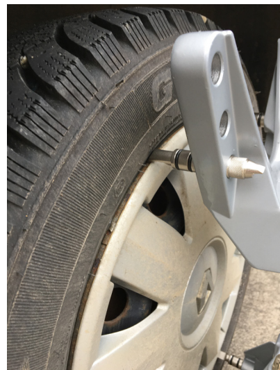
Lång gripsida vid monterade navkapslar
