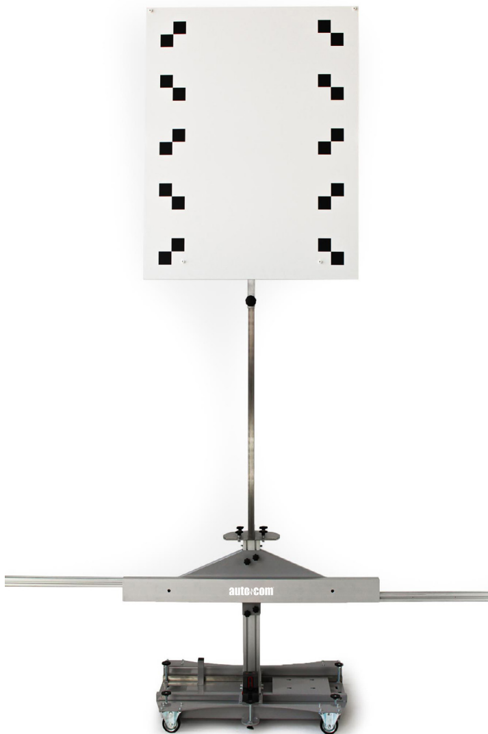
Kalibreringstavlan i högsta läget för kalibrering på lastbil
