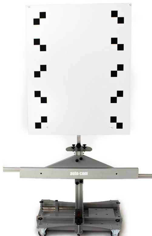
Kalibreringstavlan i lägsta läget för kalibrering på bussar
