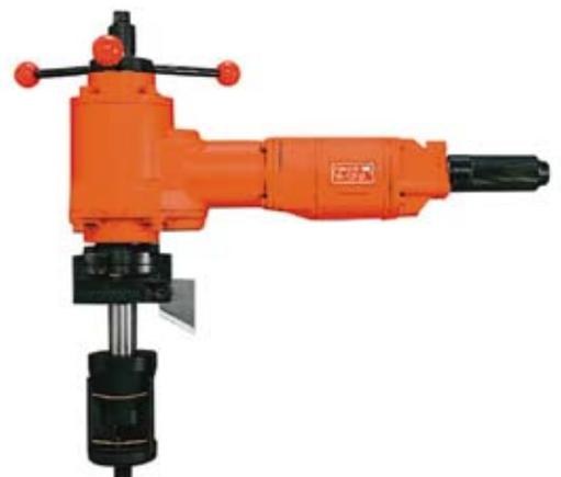
パイプ溶接用の開先加工機は小型軽量・強力で、しかもパイプ内径チャッキング機構の採用により作業性がよく、各種のパイプ(内径12mm~240mm)を開先加工します。
