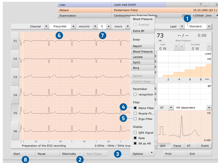
Afb. 117: Monitoring en controle van de elektroden
