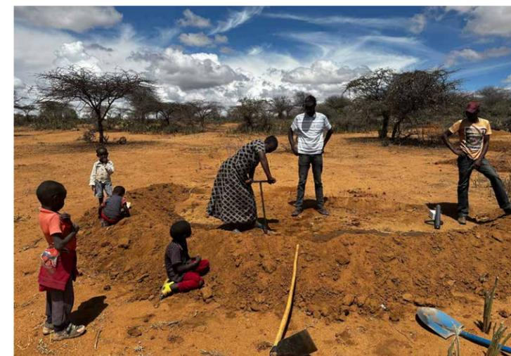
Installation von Bodenfeuchte- und Temperatursonden zum verbesserten Monitoring von halbmondförmigen Erdwällen im Naibunga County, Kenia
