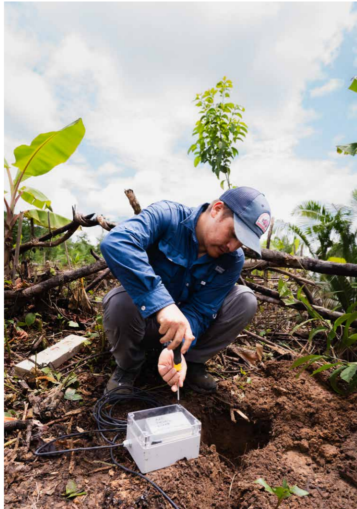
Alejandro Portillo, Senior Research Associate, installiert Bodenfeuchtesensoren bei der Asociación de Agricultura Ecológica. Foto: Alex Huarecallo
