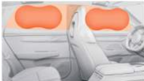
Раскрытие воздушных завес
