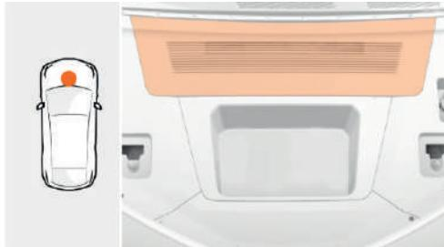
Чтобы поддерживать нужную температуру в силовом агрегате автомобиля, через него проходит охлаждающая жидкость. Необходимо регулярно проверять уровень охлаждающей жидкости и поддерживать его на уровне MIN и MAX отметки.
