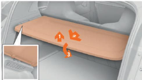
Для установки маскировочной панели выполните действия по снятию в обратном порядке.
