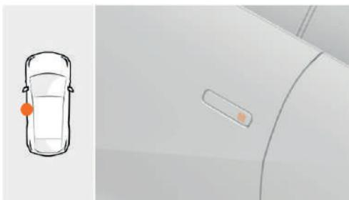
Необходимо поместить четыре пальца в зазор дверной ручки и потянуть дверь на себя. Электронный переключатель на ручке активирует дверь для самостоятельного открывания.
