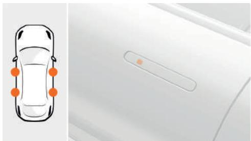
**Блокировка:** После того как все двери будут закрыты, возьмите с собой смарт-ключ Bluetooth и прикоснитесь к индукционной области на внешней дверной ручке, чтобы заблокировать автомобиль.
