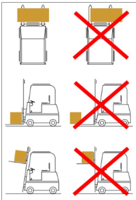
Figura 22 — Modi corretti e non corretti di utilizzo del carrello elevatore
