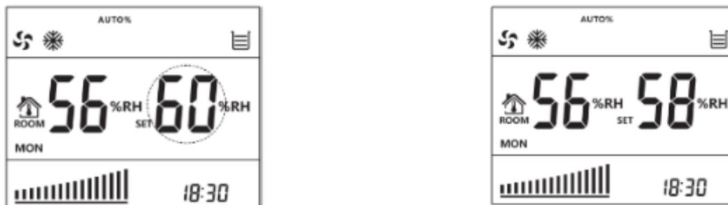
Figura 14 — Regolazione dell'umidità
