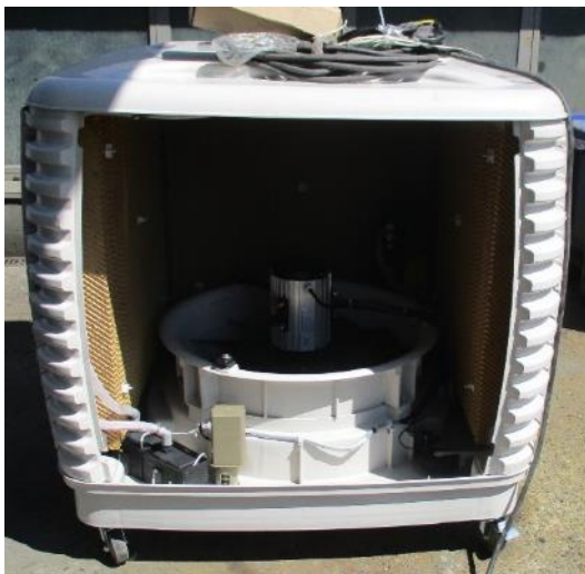
Foto 4 — Elementi costitutivi principali del raffrescatore evaporativo AQU 30.000
