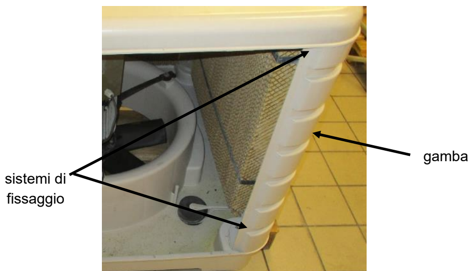
Foto 16 — Fissaggio della gamba alla struttura di base ed alla sommità della macchina
