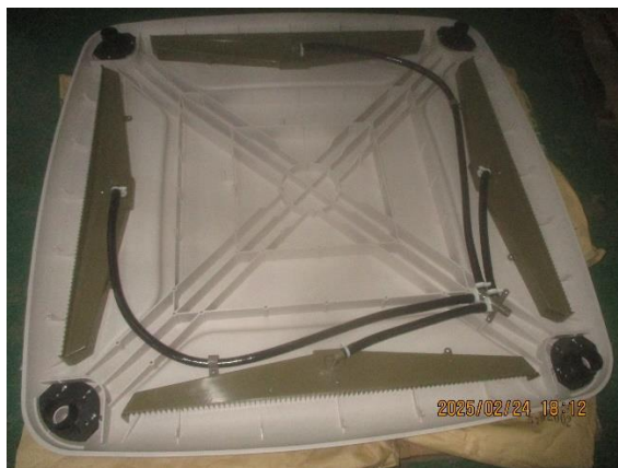
Foto 30b — Installazione tubazioni e mezzi di trattenimento
