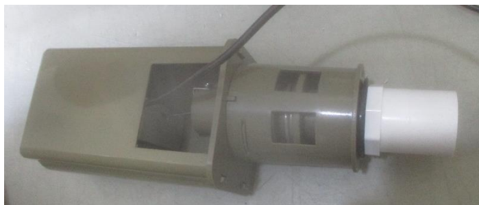
Foto 13 — Valvola di scarico dell'acqua
