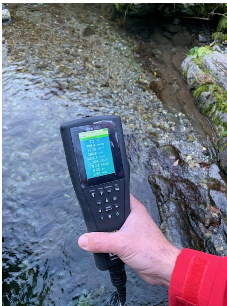
Foto 4 – Strumento portatile per la determinazione dei principali parametri fisico-chimici delle acque in corrispondenza delle stazioni di campionamento sul torrente Riso
