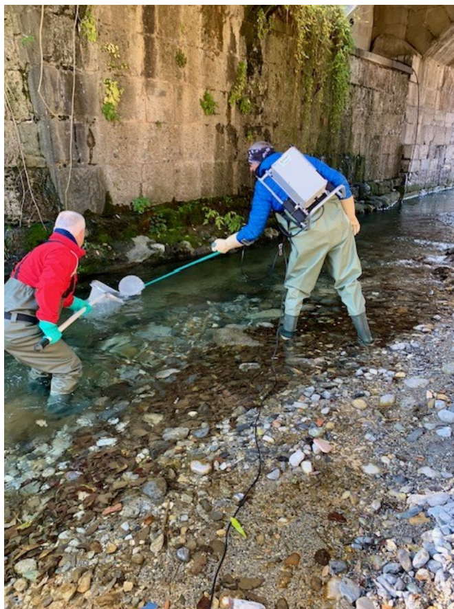
Foto 2 – Operatori in fase di campionamento ittico mediante dispositivo per l'elettropesca
