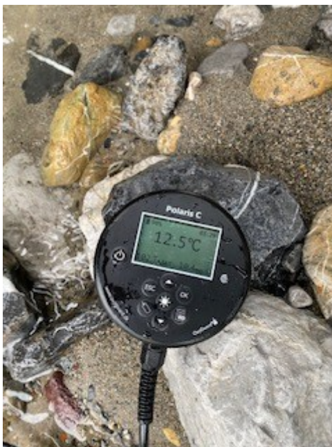
Foto 4 – Sonda portatile per la determinazione dei principali parametri fisico-chimici delle acque in corrispondenza delle stazioni di campionamento sul torrente Riso
