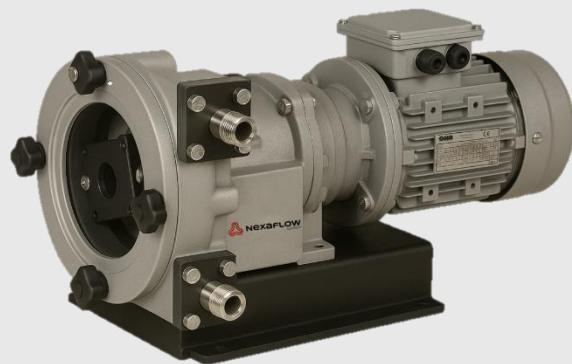
Die **Nexaflow** Schlauchpumpe ist trockenlaufsicher und absolut unempfindlich gegenüber Feststoffen. Durch geringe Scherkräfte werden empfindliche Medien schonend gefördert. Aufgrund fehlender Ventile und Dichtungen sind viskose und auch abrasive Fördermedien sehr gutförderbar.
