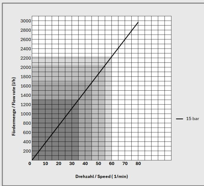
Die in der Kennlinie enthaltenen Werte sind Richtwerte, die das Förderverhalten von Wasser in Abhängigkeit vom Gegendruck darstellen. Betriebspunkte im grau hinterlegten Bereich lassen Dauerbetrieb zu. Außerhalb dieses Bereiches ist nur Kurzzeitbetrieb zu empfehlen.
