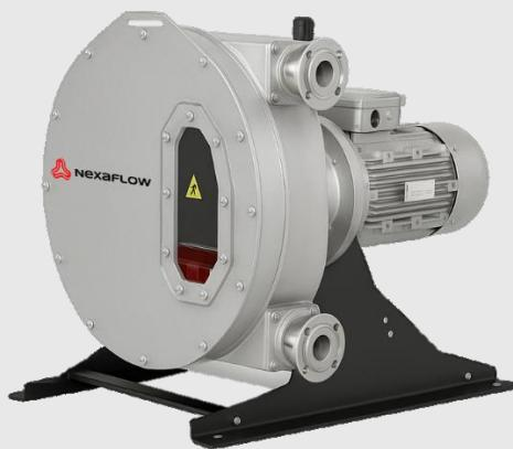
Die **Nexaflow** Schlauchpumpe ist trockenlaufsicher und absolut unempfindlich gegenüber Feststoffen. Durch geringe Scherkräfte werden empfindliche Medien schonend gefördert. Aufgrund fehlender Ventile und Dichtungen sind viskose und auch abrasive Fördermedien sehr gut förderbar.
