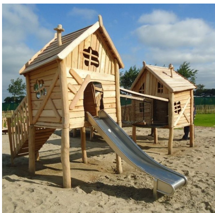
Lekhus i massivt trä — rundvirkesstolpar i robinia, panel och takdetaljer i douglasgran.
