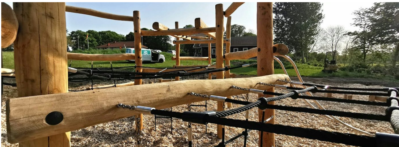
Lekkonstruktion i robinia: naturlig beständighetsklass 1–2, krokvuxen karaktär, silvergrå patina. Foto: Readymade Woods.
