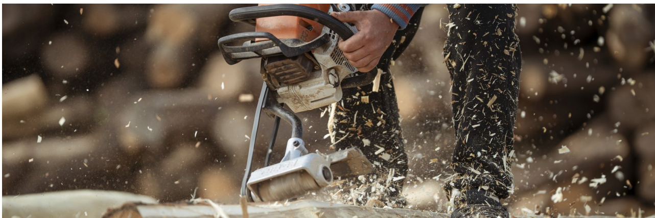
Barkning och bearbetning av robiniarundvirke — den tunna splintmanteln arbetas bort innan virket används. Foto: ROBINIO GmbH.
