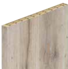
Stödsida 50 mm tjock två sidor med TopLaminat, en lång synlig sida med ABS/PP*
