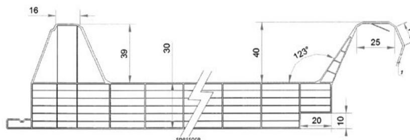
I pannelli in polycarbonato sono stati progettati per garantire un elevato isolamento termico ed una veloce installazione in abbinamento ai pannelli sandwich da copertura o per coperture continue. Da un lato presentano una greca piena, dall'altro un'ala ricurva verso l'interno per impedire il passaggio acqua con in più una piccola aletta interna per garantire maggior tenuta.
