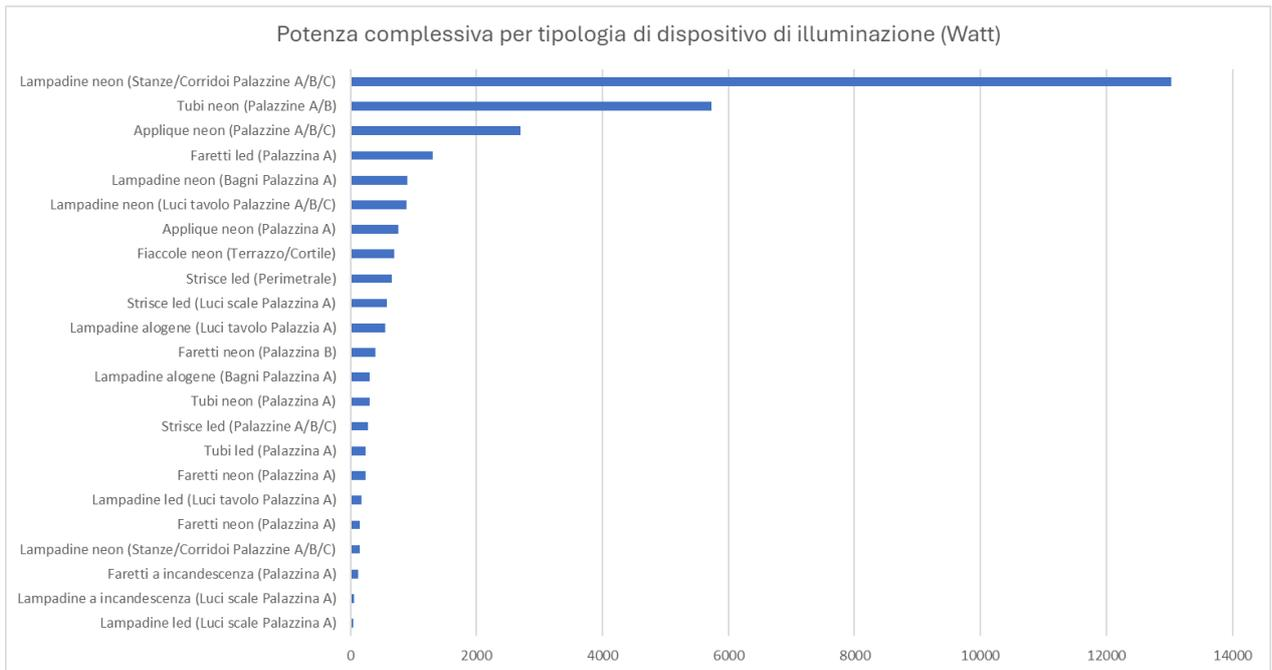
Potenza complessiva (Watt) per tipologia di dispositivo di illuminazione.
