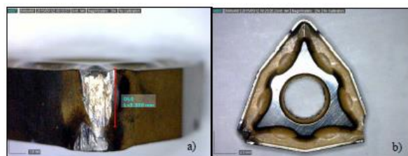
Figura 29: Desgaste da ferramenta
