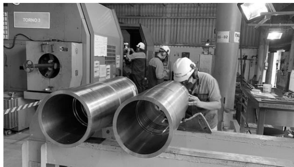
Figura 23: Tubos sob banca aguardando o processo de usinagem
